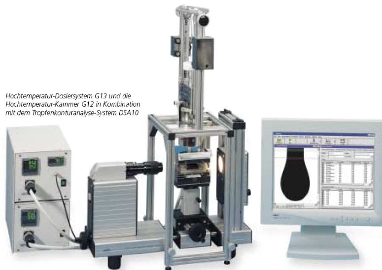
Abb. 13, Pendant Drop Messeinrichtung, Quelle: Krüss GmbH
