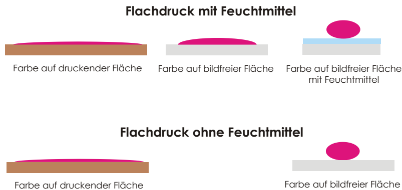
Abb. 2, Während im Nassoffset die Farbe grundsätzlich auch die bildfreien Partien benetzt und nur vom Feuchtmittel ferngehalten wird, benetzt sie Silikon erst gar nicht
